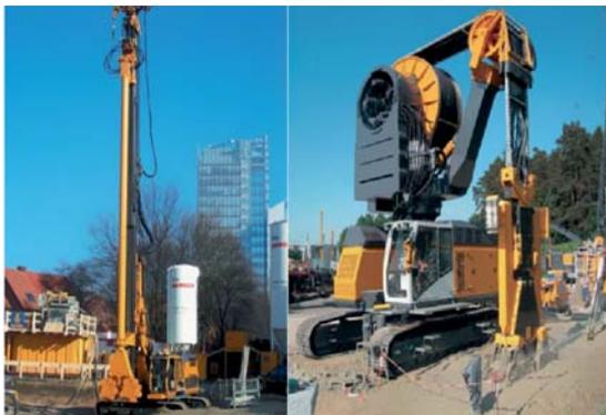
Ilust. 27: Guiado Kelly CSM y cortador lateral tandem suspendido por cuerda en MT 75
