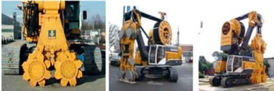
Ilust. 30: Equipo cortador de mezcla de suelos
